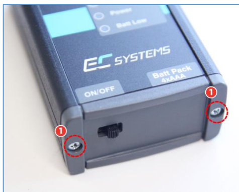
Fotografia 4.1 Widok wkrętów umożliwiających dostęp do pojemnika na baterie.
