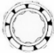
Brak smaru zwiększa Amplitudę ultradźwięków
